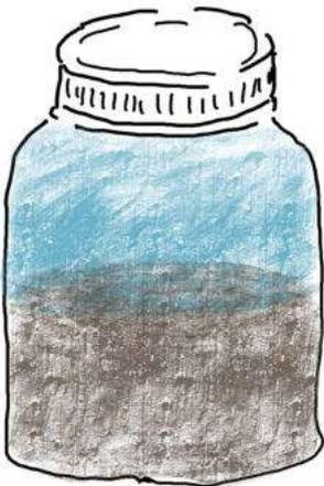
Boden besteht selten rein aus Ton oder Sand, er ist vielmehr ein Gemisch aus Partikeln unterschiedlicher Größen. Um die im Boden enthaltenen Anteile zu bestimmen, werden ca. 2 cm Bodenprobe aus dem Mineralhorizont (ca. 30 cm Tiefe) in ein Einmachglas gefüllt und der Rest wird mit Wasser aufgefüllt. Dazu 1 TL Geschirrspülmittel geben, um die Bodenpartikel zu trennen. Glas fest verschrauben, gut schütteln und 24 Stunden bei Raumtemperatur ruhen lassen.
