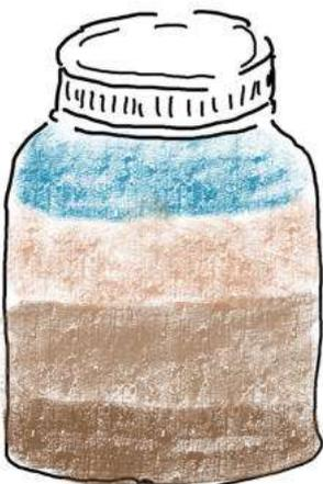
Nach 24 Stunden haben sich die Bodenpartikel entsprechend ihrer Dichte im Glas abgesetzt. Zu oberst befindet sich Wasser, dann Ton, Schluff und am Boden Sand.
