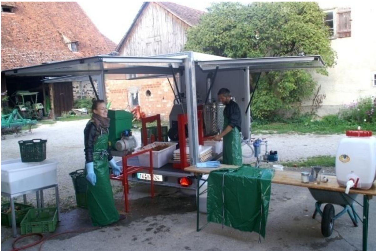
Abbildung 5: Mosten vor dem Abholraum in Waldhausen: Waschwannen und Mühle (links), Pressen (Mitte), Frischsaft (rechts), Pasteur im hinteren Teil des Anhängers (Mitte kaum sichtbar)
