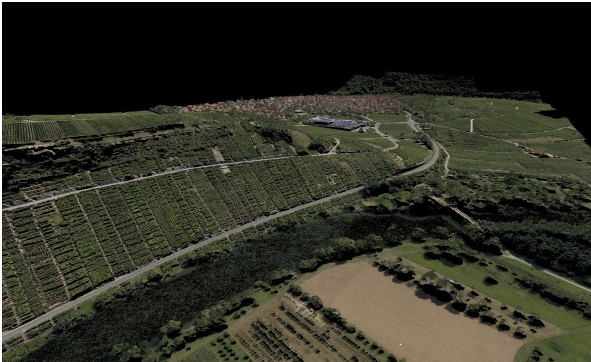
Abbildung 2: DOM Punktwolke aus der SURE Software bei 5 cm Bodenauflösung. Es handelt es sich hier um die Variante „400 Punkte/m 2 “, gewonnen durch Drohnenbefliegung (5 cm Auflösung = 20 x 20 Punkte je m 2 ). Im Rahmen der aktuellen Streuobsterhebung wurde jedoch die Variante „6,25 Punkte/m 2 “ verwendet. Dargestellt sind Streuobstbestände bei Hessigheim (Enz) im Vordergrund. Am Steilhang besteht Weinbau (Quelle: nFrames GmbH / IGI mbH)
